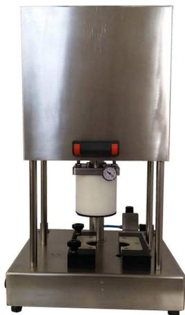
La tapadora de botes con vacío neumática semiautomática está diseñada para el cierre botes de diferentes formatos, redondos o cuadrados mientras simultáneamente se hace vacío en su interior.
