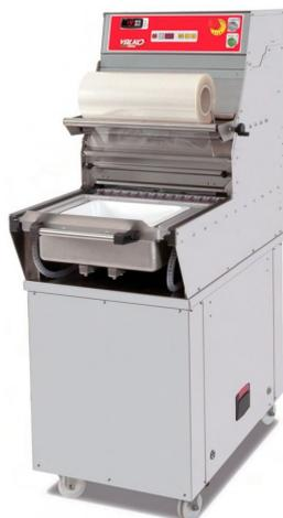
UNICA 25 es la termoselladora al vacío en atmósfera protegida, con mueble sobre ruedas, diseñada para el envasado al vacío de bandejas de diferentes medidas, dedicada a charcuterías, supermercados, caterings, etc..
