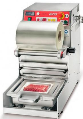
Las termoselladoras al vacío de mesa en atmósfera protegida serie MICRA, construidas en acero inox y aluminio, responden a las múltiples exigencias de envasado de la distribución alimentaria moderna. La facilidad y rapidez de la sustitución de los moldes hacen posible el envasado al vacío de varios tipos de bandeja.
