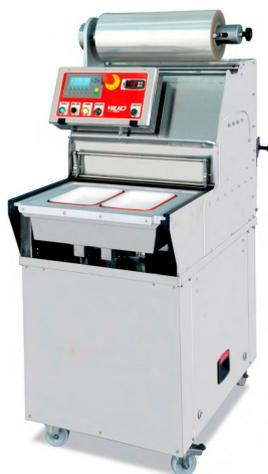
TVG MAXI es la termoselladora al vacío en atmósfera protegida, con mueble sobre ruedas, diseñada para el envasado de bandejas de diferentes medidas, dedicada a charcuterías, supermercados, caterings, etc.. En la versión SKIN permite el envasado de recipientes de diferentes tamaños con la técnica de skin pack
