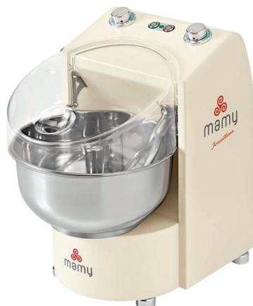
Dimensiones: 335x505x565 mm Volumen de cuba: 10 Lt Capacidad de carga 7 Kg Velocidad variable: 22/50 min. Potencia del motor: 0,5 kW Alimentación: 230/1/50 Hz Peso: 44 Kg
